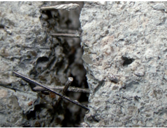
Abb. 4 a: Dreidimensionale Verteilung der Edelstahlfasern im Riss der Mörtelmatrix eines Probekörpers nach einem Biegezugversuch
