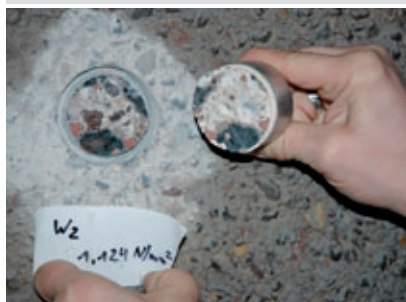
Abb. 3b: Die Prüfwerte für die Haftzugfestigkeit der alten Oberfläche bewegten sich unter 1,5 N/qmm, sodass sie konstruktiv neu aufgebaut werden mussten.
